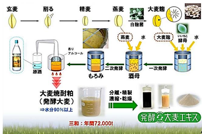
図 1. 発酵大麦エキスの生産工程 (出典：三和酒類 (株)、2016年健康博覧会資料)
